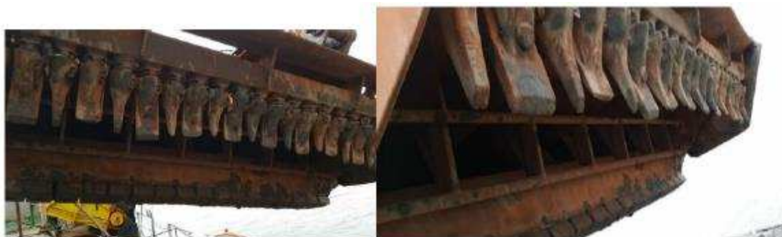
Figura 4-8: Exemplo de grades instaladas na cabeça de dragagem
